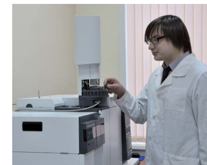
Новейшее оборудование позволяет НИИ химии антиоксидантов НГПУ проводить серьезные исследования. На фото: газовый хроматограф с масс-детектором.
